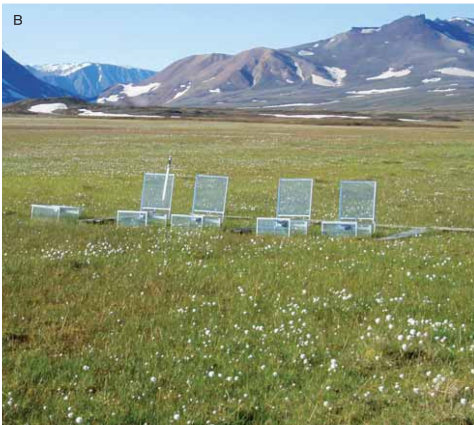
7. Våde lavninger domineret af græsser og kæruld er næsten vandmattede det meste af året. Her måles frigivelsen af metan i automatiske kamre. A: i det tidligere forår når området er oversvømmet, B: midt om sommeren hvor området er sumpet og C: i den tidlige vinter (se næste side). (A,B: J.M. Falk, C: C. Sigsgaard)
