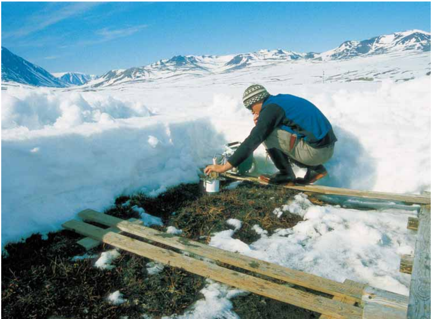
5. Jordens frigivelse af CO 2 bestemmes ved at måle koncentrationsstigningen af CO 2 i en cylinder med låg på som er presset ned i jorden. Her måles i det tidlige forår hvor der nogle år måles en uventet "bøvs" af CO 2 . (B. Elberling)
