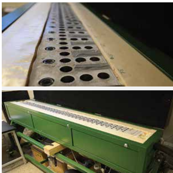
Fig. 2. Her ses permafrostprøver indsamlet ved Disko i Vestgrønland placeret i termoblok samt resultaterne i form af mikrobiel aktivitet målt som \text{CO}_2 produktion som funktion af temperatur. Foto: Bo Elberling.
