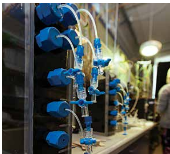
Fig. 4. Foto fra Zackenberg i 2012 hvor en række mesokosmer blev hjembragt for at studere, i hvilken omfang metan ( \text{CH}_4 ) produceret i nyoptøet permafrost kan iltes til kuldioxid ( \text{CO}_2 ) i den mere eller mindre iltrige overjord. Foto: Fra feltet af Bo Elberling og fra laboratoriet af Kent Pørksen.
