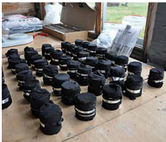
Fig. 5. Her ses rækker af permafrostkerner pakket og klar til at blive placeret i forskellige dybder i aktivlaget. Disse forsøg er sat i gang både i Zackenberg (Grønland) og i Kytalik (Sibirien). Foto: Bo Elberling og Daan Blok.
