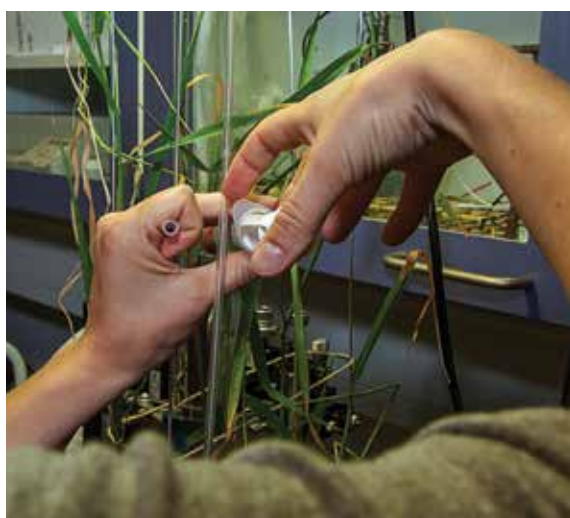
Fig. 4. Foto fra Zackenberg i 2012 hvor en række mesokosmer blev hjembragt for at studere, i hvilken omfang metan ( \text{CH}_4 ) produceret i nyoptøet permafrost kan iltes til kuldioxid ( \text{CO}_2 ) i den mere eller mindre iltrige overjord. Foto: Fra feltet af Bo Elberling og fra laboratoriet af Kent Pørksen.
